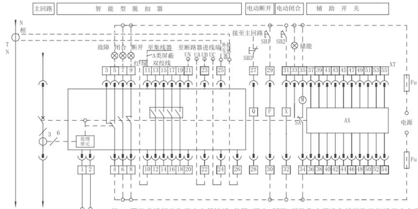
注:1.图示虚线部分为用户自行接线;故障、闭合、断开、储能和合闸就绪指示灯请用户自备。
