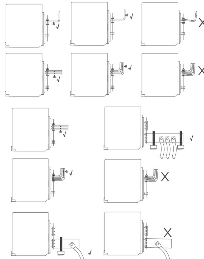
提示:接线排应和产品的安装面保持水平/垂直,在接线排和产品接线端锁紧后,接线排不能对产品产生额外的力。
