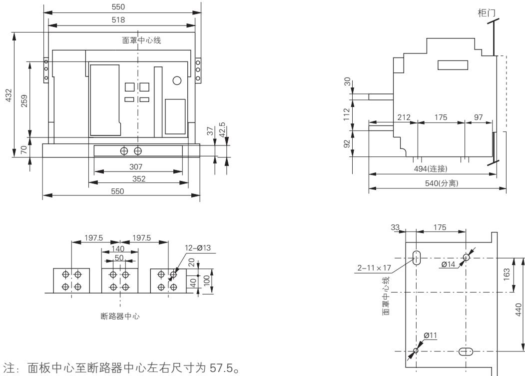
图 46 抽屉式断路器安装尺寸及外形尺寸 (BW1A-4000/3)
