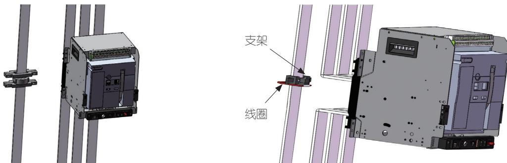
注：将柔性互感器按图示安装在母排上，互感器导线连接在二次回路。红色接 25，绿色接 26 号。
