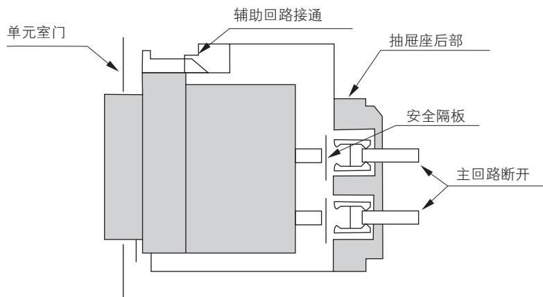
“试验”位置：主回路断开，安全隔板关闭，仅辅助回路接通，可进行必要的动作试验。
