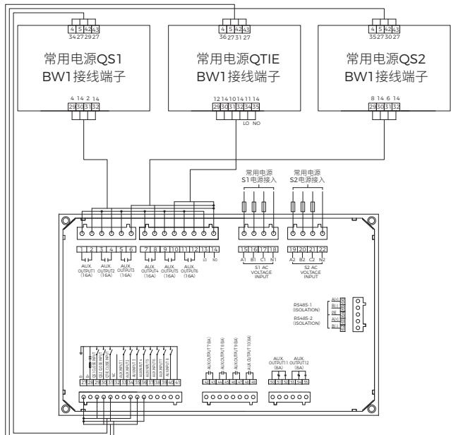
BWQ5T3 双电源母联自动切换控制器接线图
