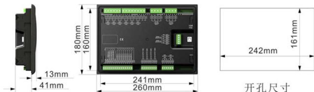
该控制器设计为面板安装式，安装时由卡件固定。
