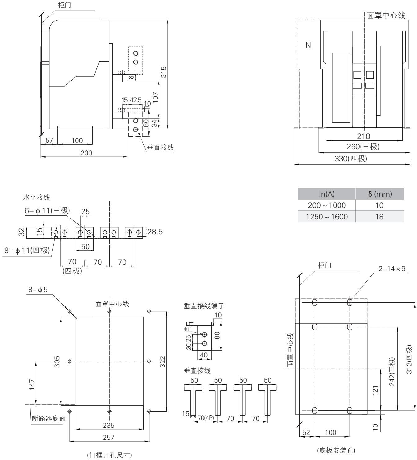
图 37 固定式断路器安装尺寸及外形尺寸 (BW1A-1600)
