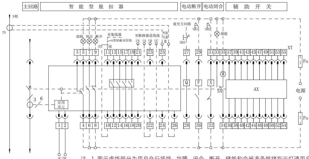
注：1. 图示虚线部分为用户自行接线；故障、闭合、断开、储能和合闸准备就绪指示灯请用户自备。
