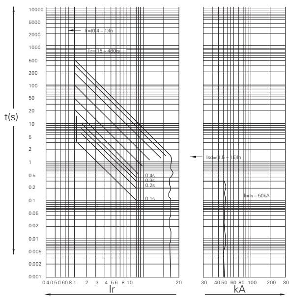
图 12 过电流脱扣保护特性
