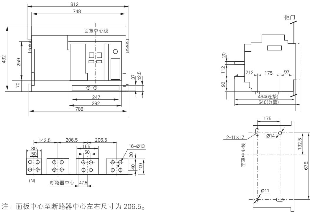
图 47 抽屉式断路器安装尺寸及外形尺寸 (BW1A-4000/4)
