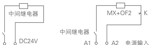
注：1、当控制回路电源电压为 DC24V 时，推荐采用上图进行分励控制回路设计。
