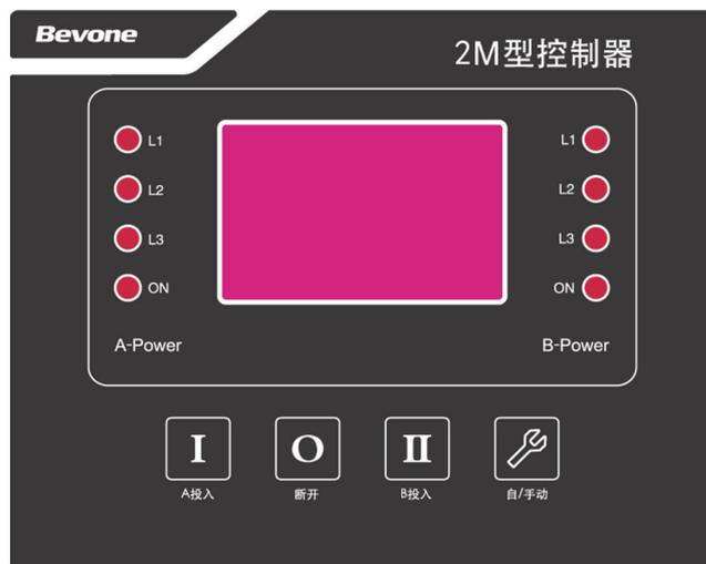
图 3 2M 型控制器面板示意图
