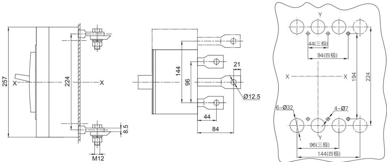
BM3-400 ( C、L、M、H ) 插入式板后接线 ( 三极、四极 )
