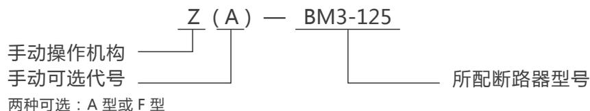
手动操作机构安装在断路器外盖上，其手柄安装在电气控制柜面板上，通过旋转手柄来达到接通，分断和再扣的目的，并具有事故脱扣、复位指示和联锁功能，即控制柜门开启状态时，手动操作不能分合断路器，相反手动操作处于接通位置时，控制柜门不能打开。
