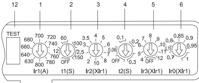
BM3E-800, In=800A 电子式脱扣器 (G 型接地保护)
