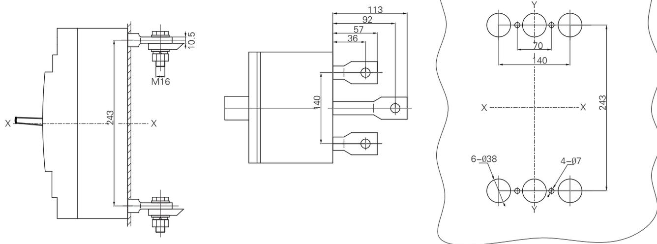
BM3E-630M/H 塑壳断路器插入式板后接线
