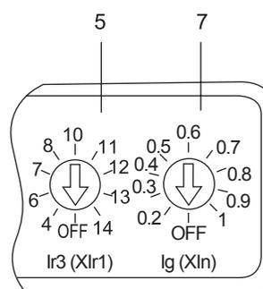
BM3E-630, In=630A 电子式脱扣器
