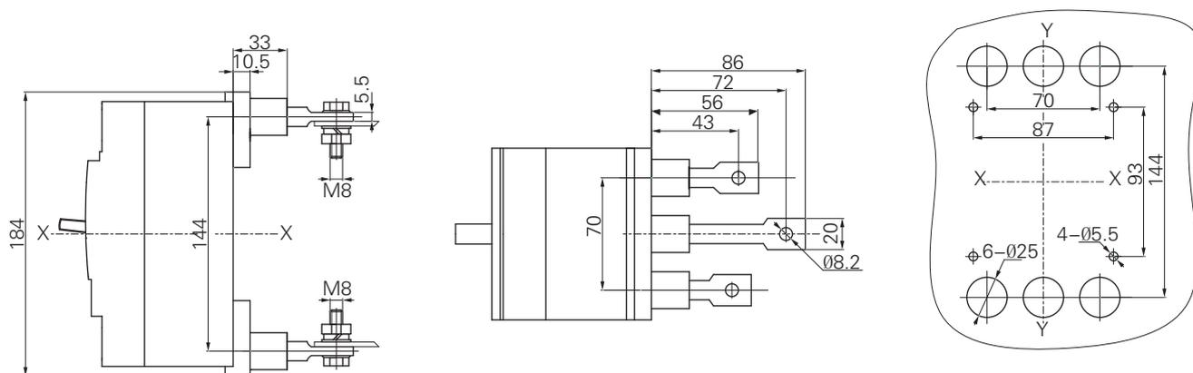
BM3E-250M/H 塑壳断路器插入式板后接线
