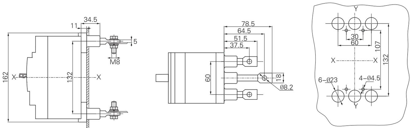
BM3E-125M/H 塑壳断路器插入式板后接线
