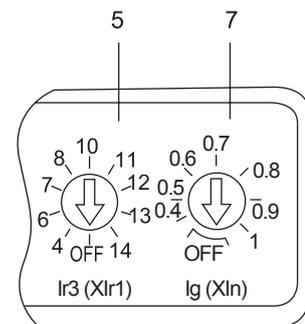
BM3E-125, In=63A 电子式脱扣器
