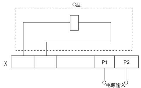
欠电压脱扣器功率
