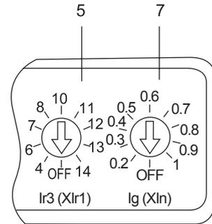
BM3E-800, In=800A 电子式脱扣器
