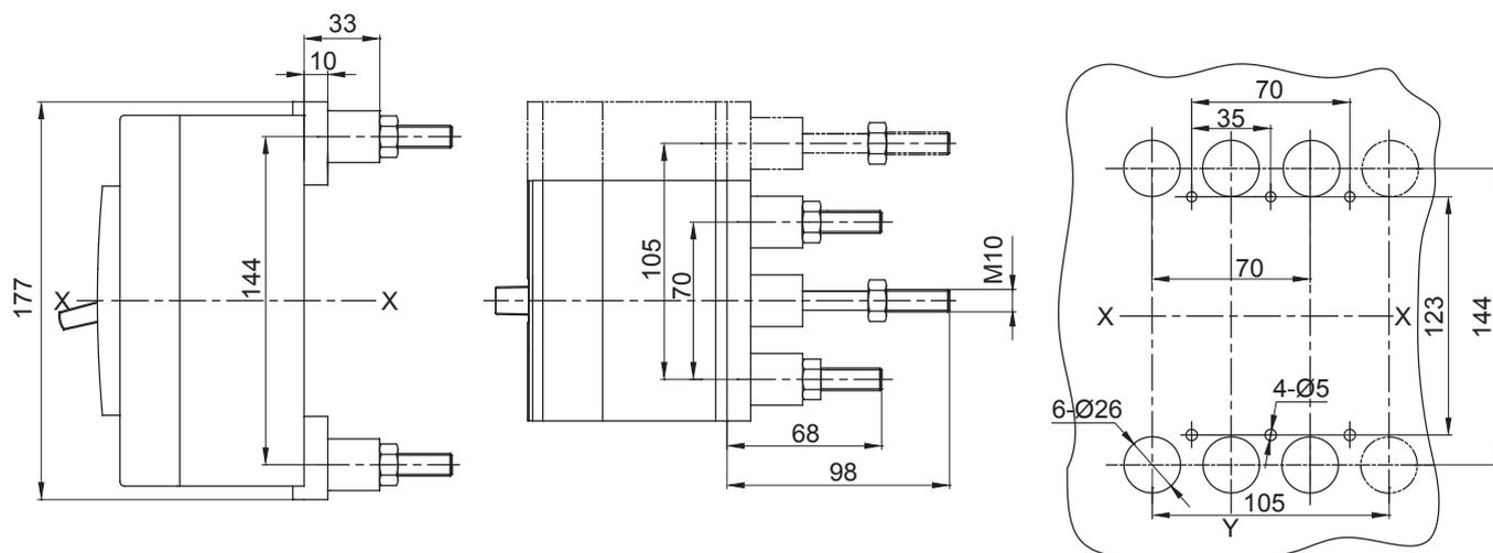
BM3-250 ( C、L、M、H ) 插入式板后接线 ( 三极、四极 )
