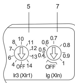
BM3E-250, In=250A 电子式脱扣器
