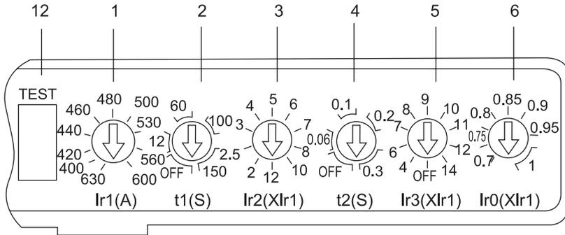
BM3E-630, In=630A 电子式脱扣器 (G 型接地保护)
