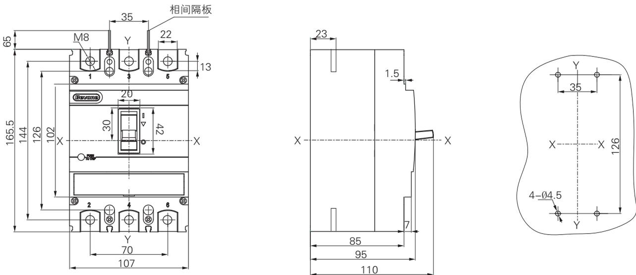
BM3E-250M/H 塑壳断路器板后接线
