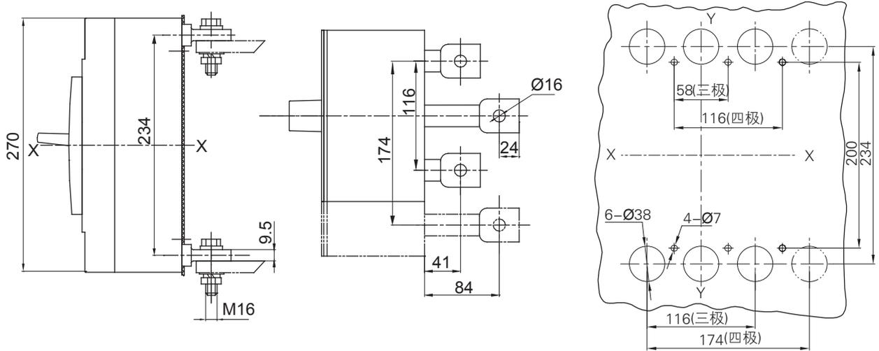
BM3-630 ( C、L、M、H ) 插入式板后接线 ( 三极、四极 )
