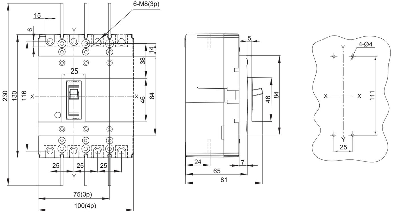
BM3-63(L、M) / BM3-100C 插入式板后接线 ( 三极、四极 )
