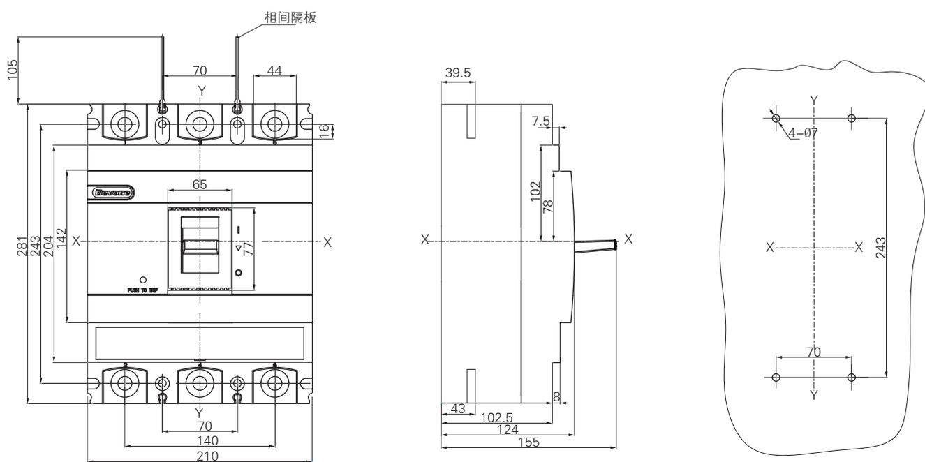
BM3E-630M/H 塑壳断路器板后接线
