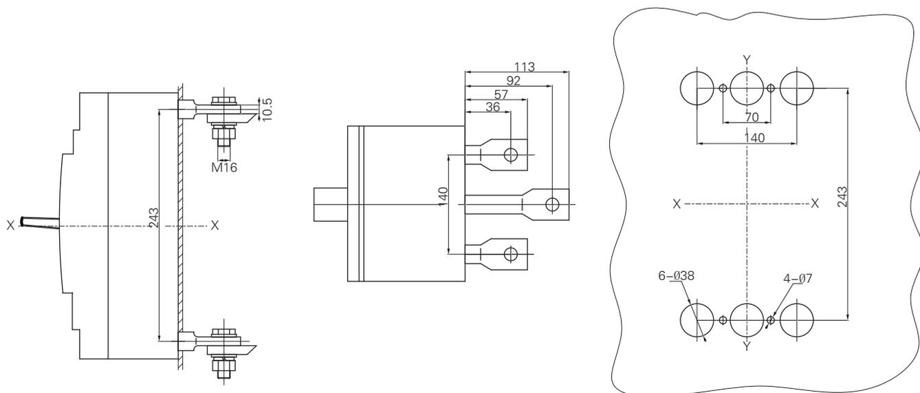
BM3E-800M/H 塑壳断路器插入式板后接线
