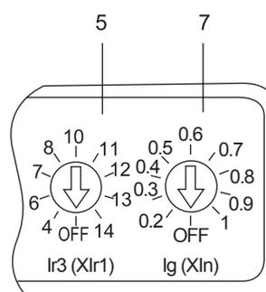
BM3E-400, In=400A 电子式脱扣器
