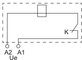
K: 分励脱扣器内部与线圈串联的微动开关常闭触头，当断路器分闸后、该触头自行断开，合闸时闭合。
