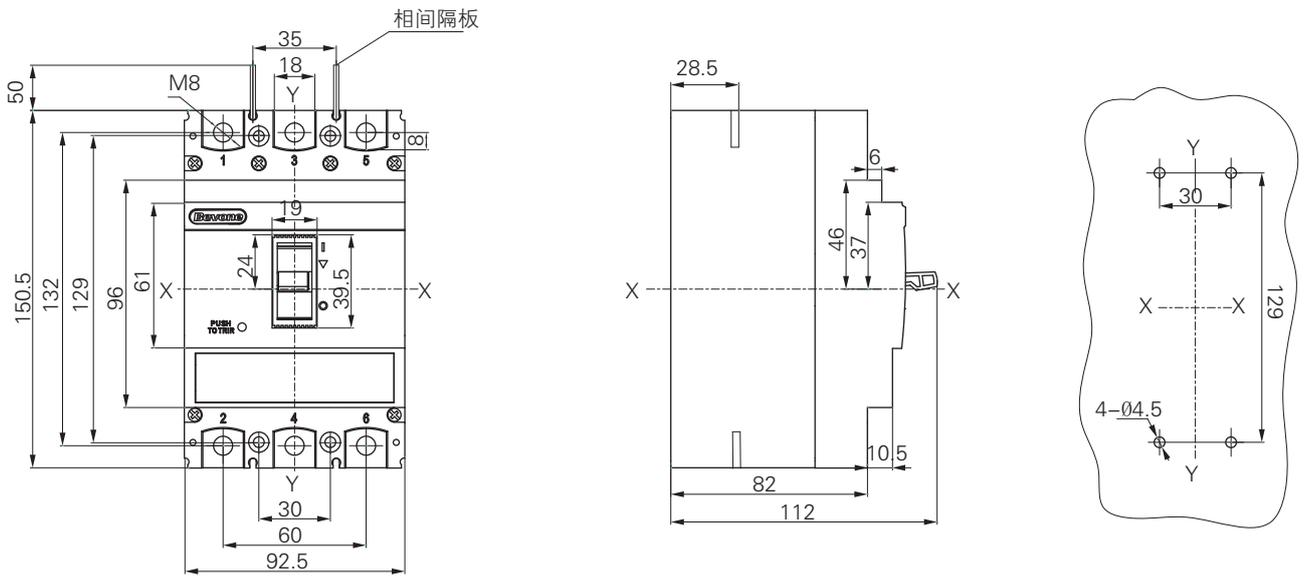
BM3E-125M/H 塑壳断路器板后接线
