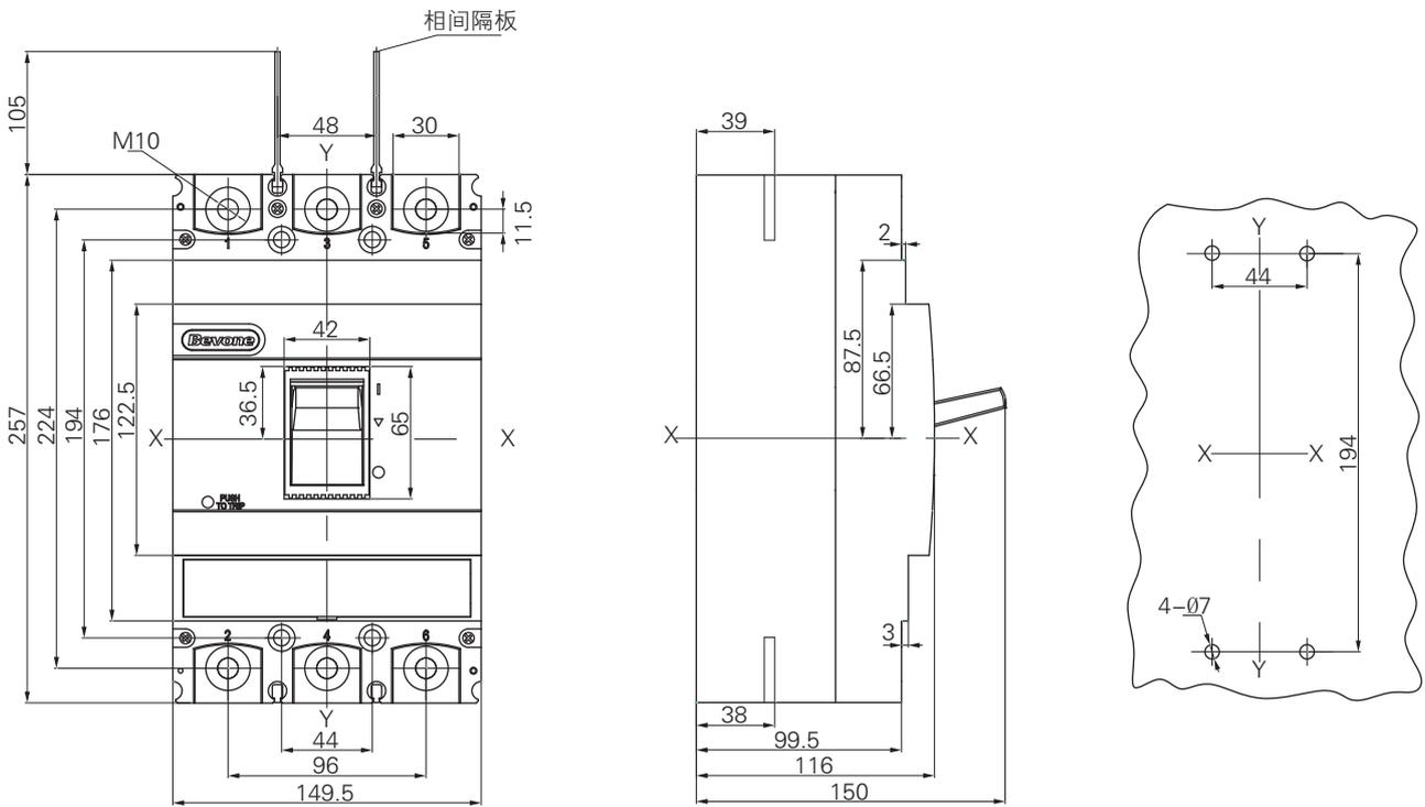
BM3E-400M/H 塑壳断路器板后接线
