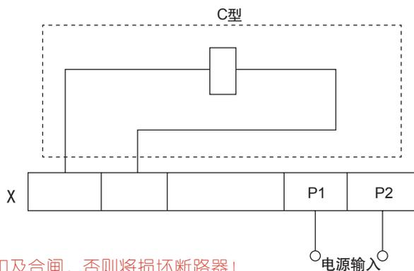
**警告：欠电压脱扣器必须先通电，断路器才能再扣及合闸，否则将损坏断路器！**
