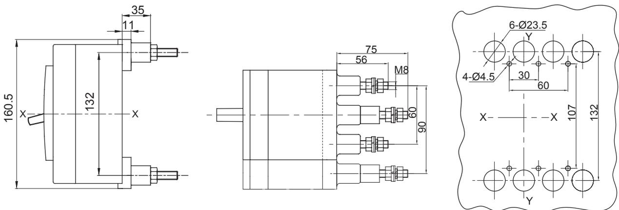
BM3-125 (C、L、M、H) 插入式板后接线 (三极、四极)
