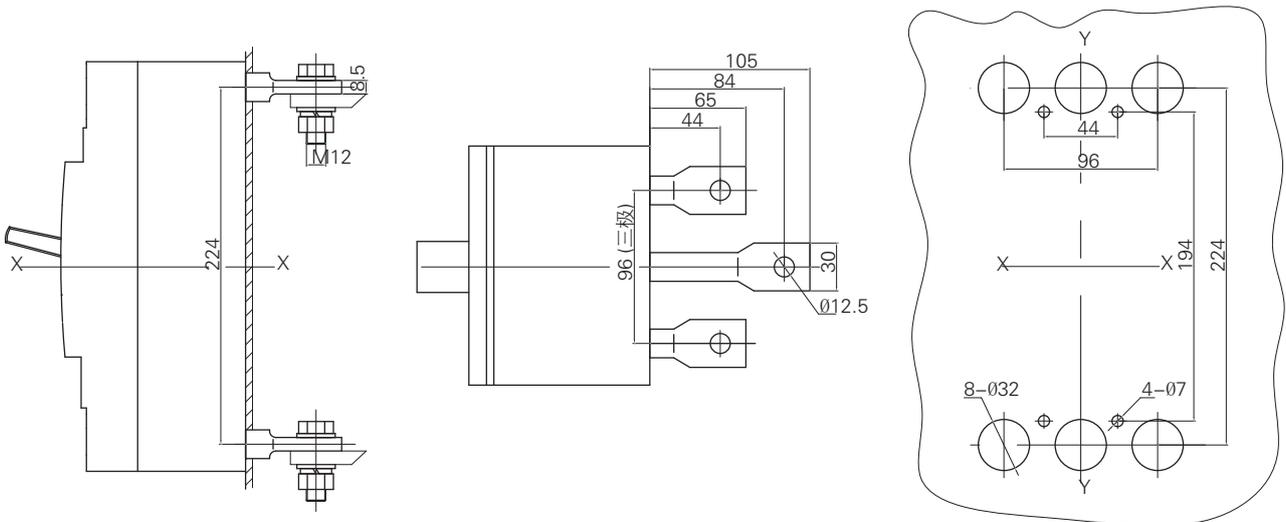
BM3E-400M/H 塑壳断路器插入式板后接线
