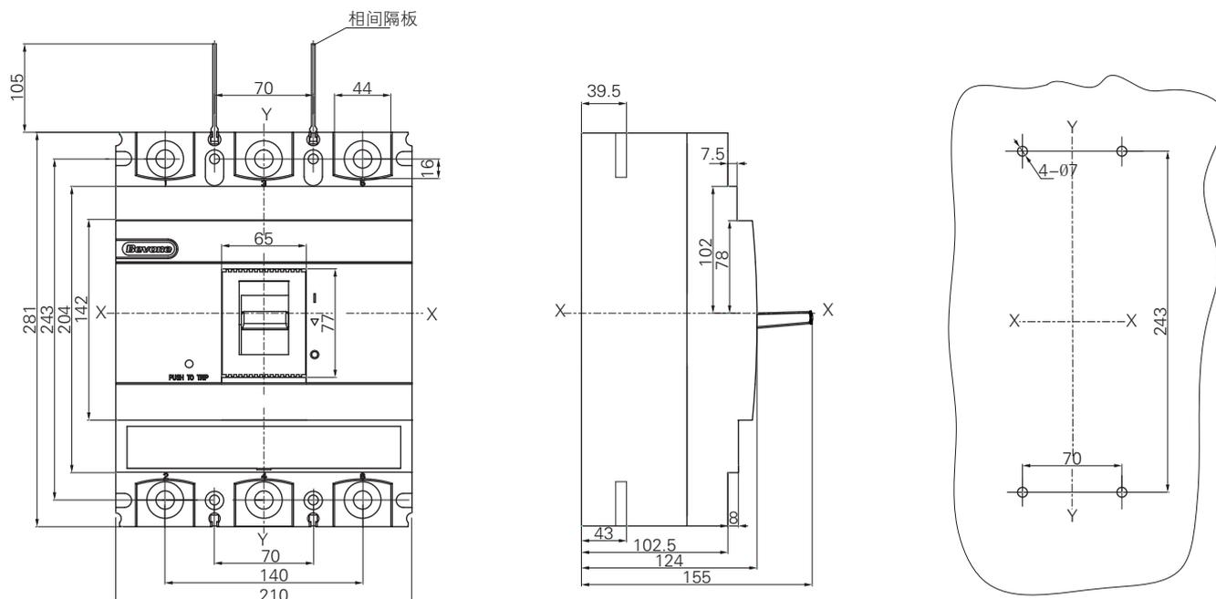
BM3E-800M/H 塑壳断路器板后接线
