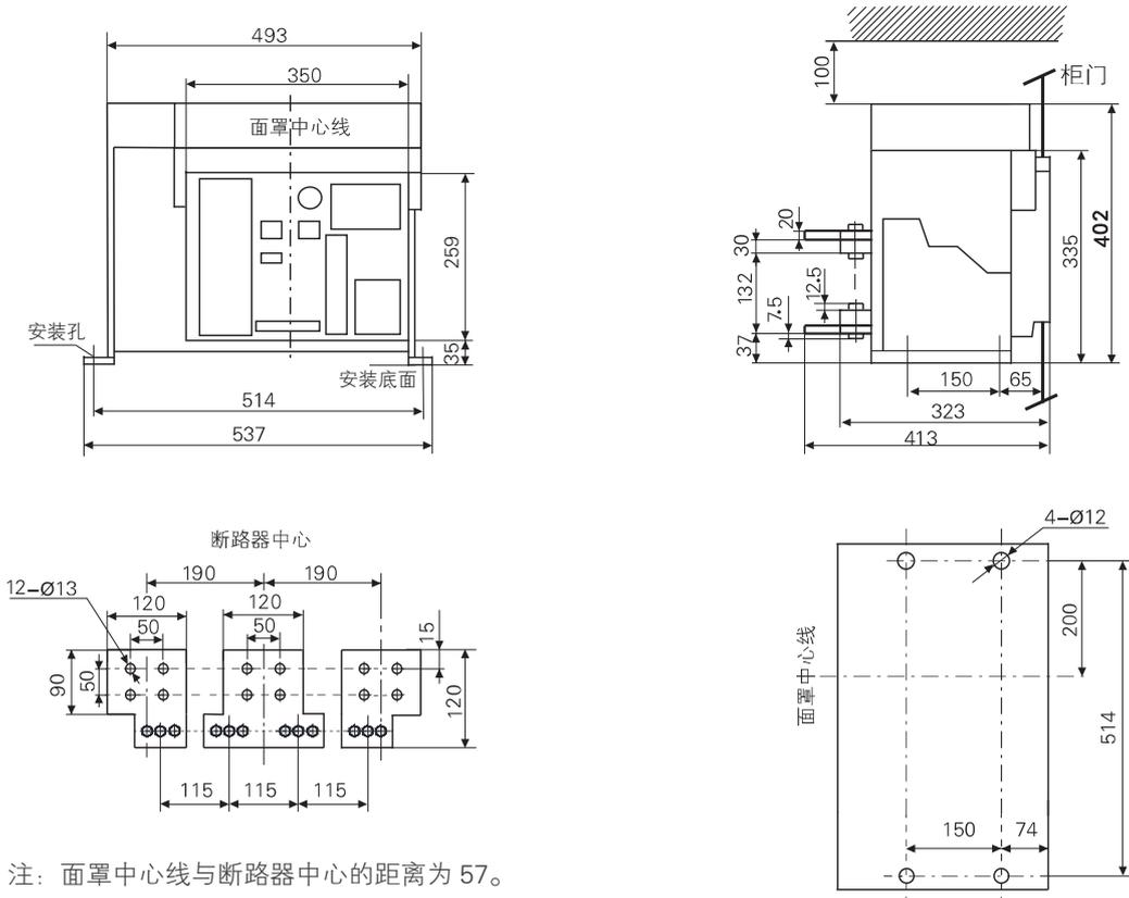
图 40 固定式断路器安装尺寸及外形尺寸 (BW1A-4000/3)
