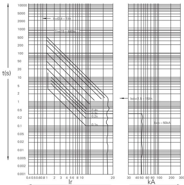
图 12 过电流脱扣保护特性
