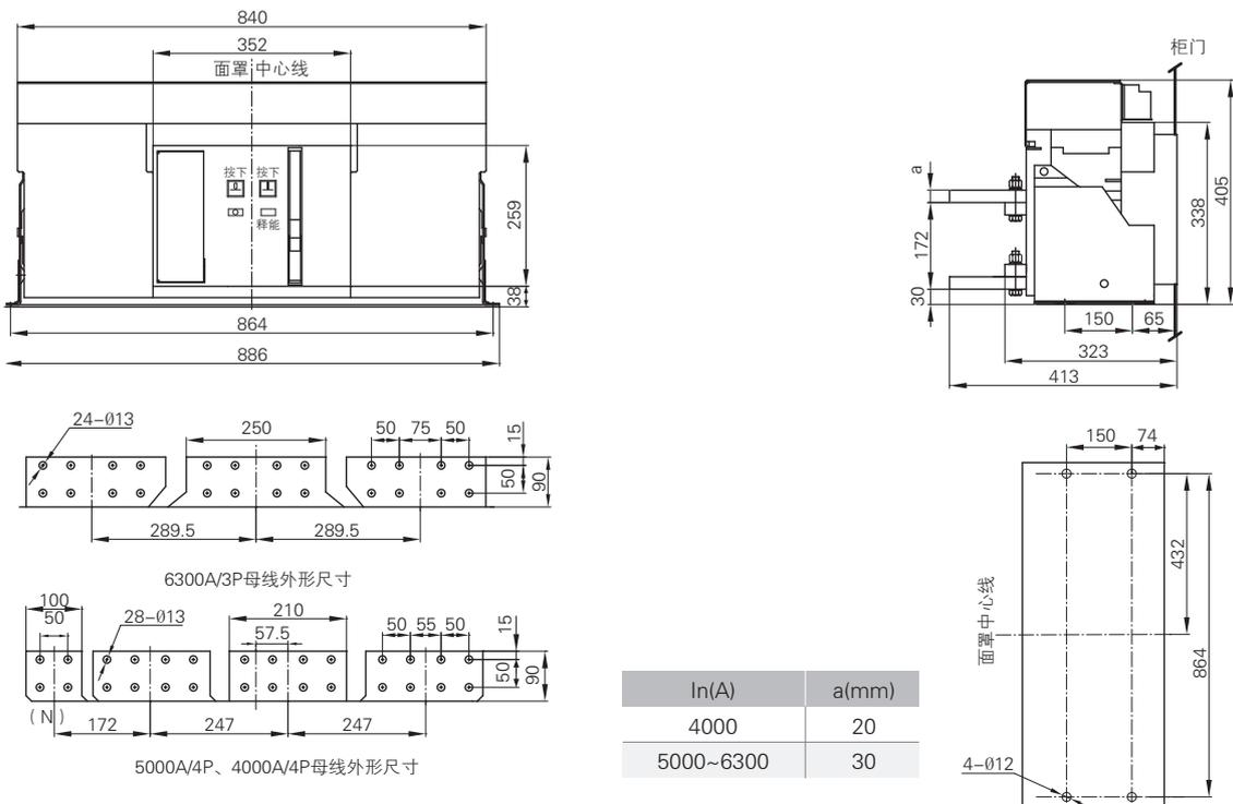
图 41 固定式断路器安装尺寸及外形尺寸 (BW1A-6300 4000/4P、BW1A-6300 5000/4P、BW1A-6300 6300/3P)
