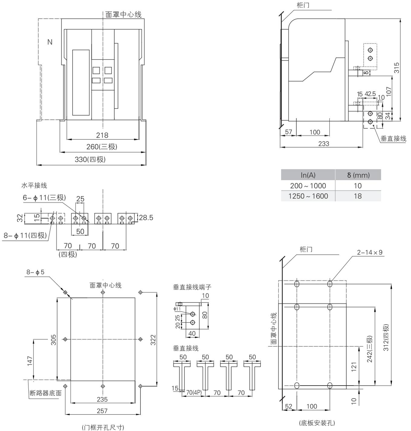
图 37 固定式断路器安装尺寸及外形尺寸 (BW1A-1600)
