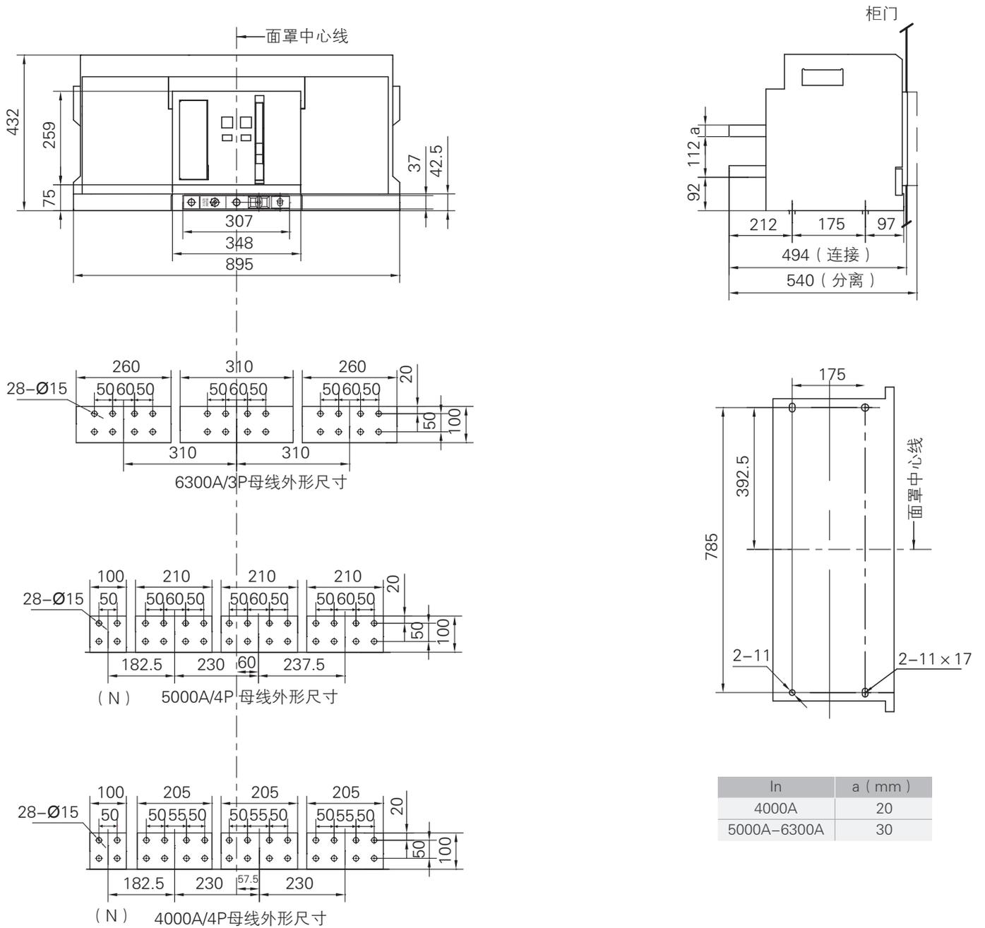
图 49 抽屉式断路器安装尺寸及外形尺寸 (BW1A-6300 4000/4P、BW1A-6300 5000/4P)、BW1A-6300 6300/3P)
