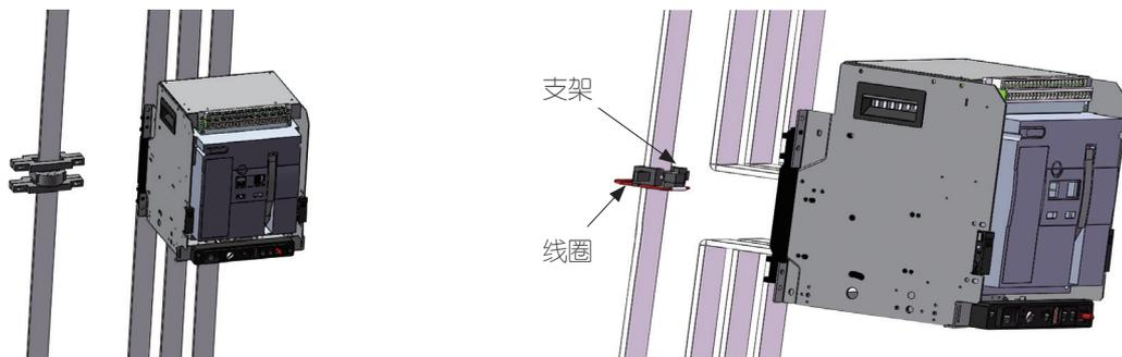
注：将柔性互感器按图示安装在母排上，互感器导线连接在二次回路：红色接 25 号，绿色接 26 号。导线标准配置 3 米。
